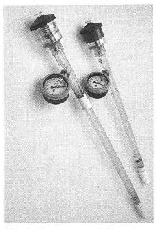
Abb. 3: Tensiometer mit Unterdruckmanometer und Wasserreservoir.
