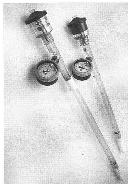
Abb. 3: Tensiometer mit Unterdruckmanometer und Wasserreservoir.
