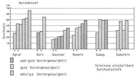
Abb. 7: Resultate Maishäcksel (ca. 30% TS). Die Förderung von Maishäcksel sollte mit Durchsätzen unter 20 t/h möglich sein. Ausser beim Gerät Gassner mit speziellem Maisgetriebe muss dazu mit dem Kratzboden dosiert werden. Die Durchsätze auf der niedrigsten Durchsatzstufe variierten bei einzelnen Geräten sehr stark.
