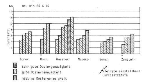
Abb. 5: Resultate Welkheu. Bei mehreren Geräten stellten wir bei steigendem Durchsatz eine Verschlechterung der Dosiergenauigkeit bei der Dosierung von Welkheu fest. Dies ist auf Stauungen am Dosieraggregat zurückzuführen.
