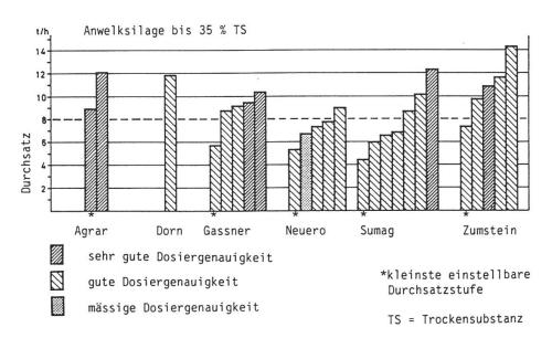
Abb. 3: Resultate Anwelksilage unter 35% TS. Die Höhe der Balken gibt an, mit welchem Durchsatz in den einzelnen Versuchsdurchgängen gearbeitet wurde. Die Schraffur gibt einen Hinweis auf die dabei erzielte Dosiergenauigkeit. Für ein verstopfungsfreies Arbeiten mit dem Gebläse sollten Durchsätze unter 10 t/h, besser unter 8 t/h möglich sein.
