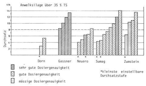
Abb. 4: Resultate Anwelksilage über 35 TS. Alle hier auf der niedrigsten Durchsatzstufe betriebenen Geräte konnten Durchsätze unter 8 t/h fördern, das Gerät Zumstein allerdings nur mit mässiger Dosiergenauigkeit. Teilweise ergeben sich bei der niedrigsten Durchsatzstufe recht unterschiedliche Durchsätze (siehe Neuero).
