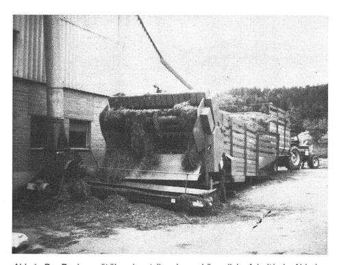
Abb. 1: Das Dosiergerät übernimmt die schwere körperliche Arbeit beim Abladen von Rauhfutter. Es hilft, die Einführleistung zu steigern, beansprucht aber relativ viel Platz.
