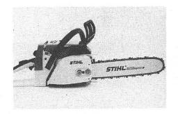
Hand. Die integrierte Kettenbremse STIHL-Quickstop löst automatisch bei entsprechend starkem Rückschlag der Säge aus und bringt in Bruchteilen von Sekunden die Sägekette zum Stillstand. Die Kettenbremse kann auch über den vorderen Handschutz mechanisch ausgelöst werden.
