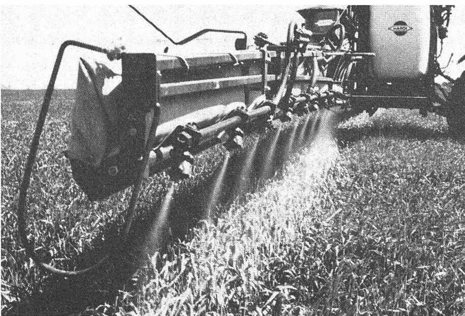
Mit Hilfe eines Luftstromes wird die Spritzbrühe über einen aufblasbaren Kunststoffschlauch in den Bestand geblasen.
