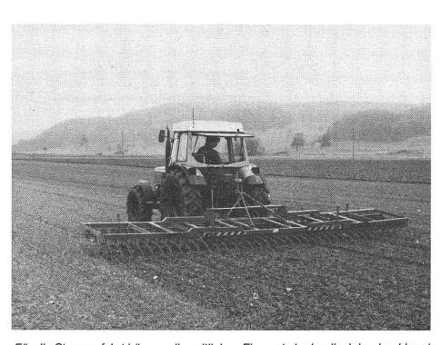
Für die Strassenfahrt können die seitlichen Elemente hydraulisch hochgeklappt werden.
