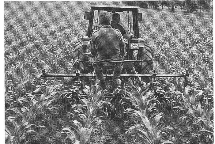
Abb. 10: Das Sternhackgerät mit 28-cm-Lockerungsscharen und spatenförmigen Hacksternen ergab in allen Einsätzen eine gute Arbeitsqualität. Beim zweitem Hacken wurden die Unkräuter in den Reihen durch Anhäufeln bekämpft.
