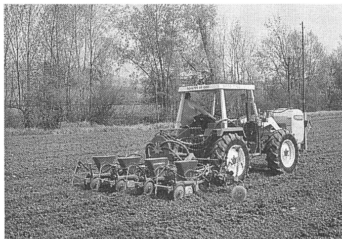
Abb. 7: Beim Frontanbau der Bandspritze können die Düsenhalter mit Schläuchen bei geringem Arbeitsaufwand an ein Hackgerät ummontiert werden.
