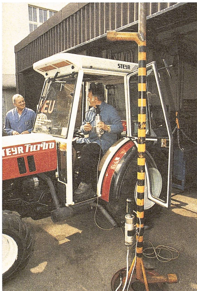
Abb. 1: Die Rauchgasmessungen sind ein wichtiger Bestandteil der Typenprüfung. (Fotos: Zw)
