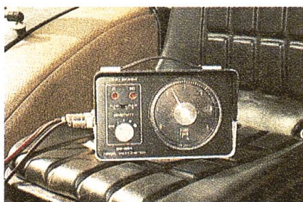
Abb. 6: Die Reduktion der Motordrehzahl unter Vollast verursacht einen stärkeren Rauchbildung. Die Werte am Traktor werden beim maximalen Drehmoment, bei 45 Prozent der Drehzahl der grössten Motornutzleistung und bei 1000 Umdrehungen pro Minute gemessen.
