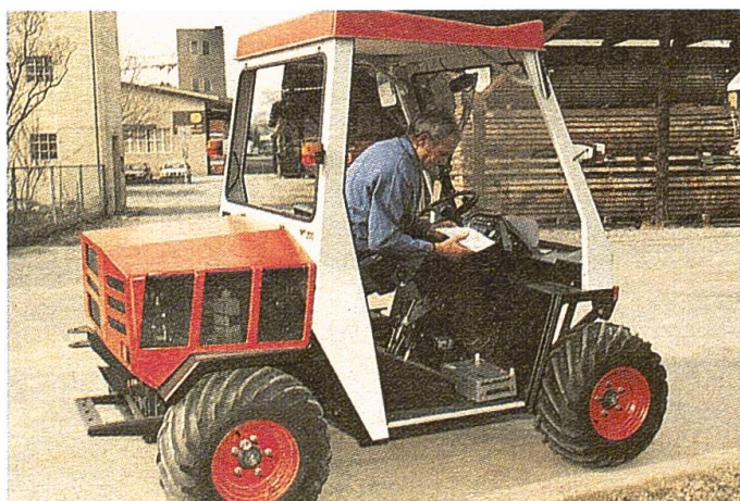
Abb. 2: Vollbremsung mit dem MT 200. Das Messgerät hält die Bremsverzögerung als Kurvenbild fest.
