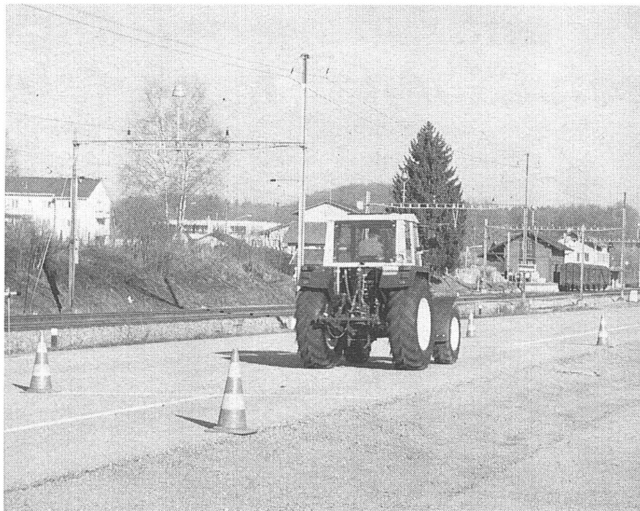
Abb. 3: Der Steyr 8090 hatte keine Lärmprobleme. Der Fahrzeuglärm bei Vorbeifahren wird zwischen den Markierungspyramiden mittels Mikrophon registriert und...
