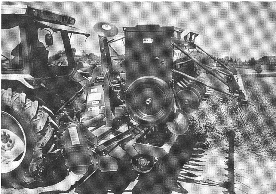
Abb. 8: Dank Huckepack wird die Sämaschine über den Zinkenrotor gehoben und somit der Hubkraftbedarf des Traktors gesenkt.
