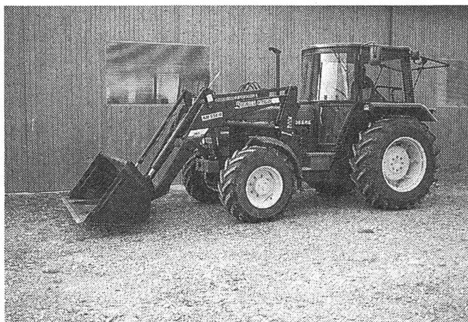
Abb. 1: Der moderne Frontlader ist in wenigen Minuten einsatzbereit. Der An- und Abbau erfolgt im Einmannsystem.
