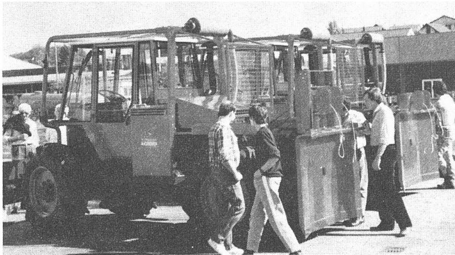
Der Mahler-Forsttraktor lässt sich universell einsetzen: sei es für die Räumung oder Durchforstung kleinerer, mittlerer oder grosser Baumbestände. Seine Abmessungen sind ideal: nicht zu gross und nicht zu klein. Das Grundfahrzeug kann durch die verschiedensten Anbau- und Spezialgeräte exakt auf die anstehenden Bedürfnisse zugerüstet werden. Beispielsweise auch für kommunale Sommer- und Winter-einsätze.
