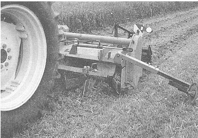
Die 25 cm breiten Saatstreifen werden beim ersten Arbeitsgang direkt in frisch gemähte Wiesen eingefräst. In der Bildmitte sichtbar: Grubberzahn, der den Boden auf Pflugtiefe lockert.
