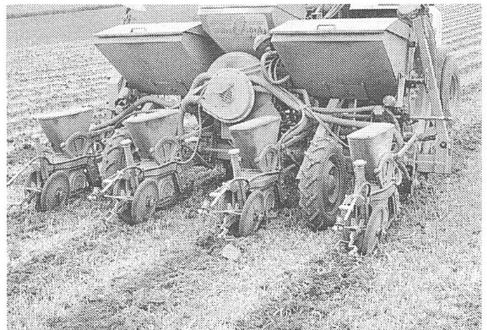
Die Saat erfolgt im zweiten Arbeitsgang mit einem normalen Einzelkornsägerät. Vorteil: Der Boden kann zuerst etwas abtrocknen.
