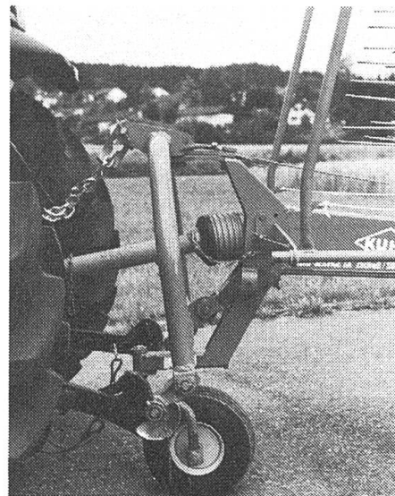
Abb. 5: Ungeübtes Personal? – Das Stützrad macht den Einsatz der Schwadmaschine narrensicher.
