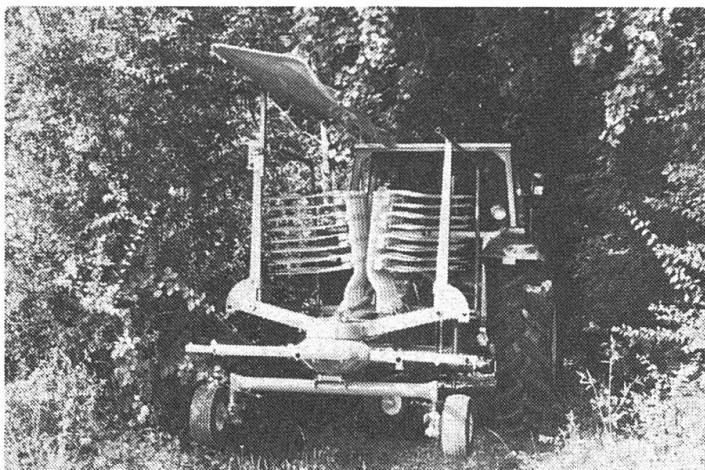
Abb. 6: Mit abnehmbaren Kreiselarmen sind enge Durchfahrten und die Remisierung kein Problem. Wo und wie die Arme aber auf der Maschine untergebracht sind, beeinflusst die Zeitdauer für das Umrüsten beträchtlich.
