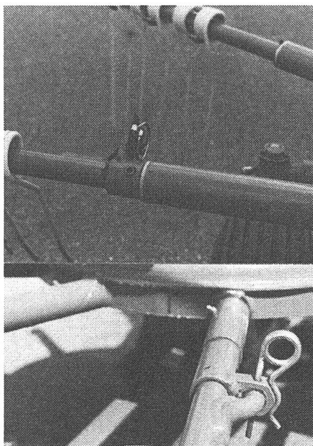
Abb. 7: Zur Sicherung der Arme eignen sich Klappsplinten eindeutig besser als Federvorstecker.
