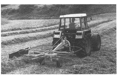
Abb. 1: Der Kreiselschwader ist noch immer die verbreitetste Schwadmaschine.
