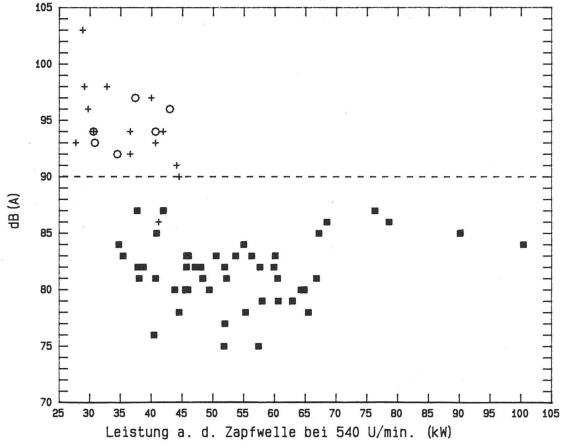
2: Gemäss den FAT-Traktortests ist der Schallpegel in neuen Fahrerkabinen 10 bis 15 Dezibel (A) tiefer. Dies entspricht von der Empfindung her mindestens einer Halbierung des Lärms.
