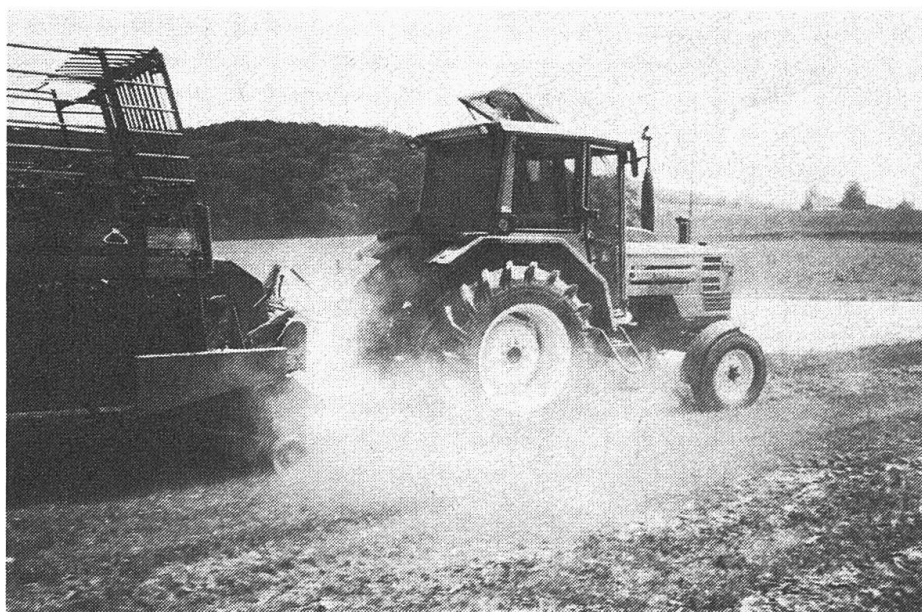
1: Moderne integrierte Sicherheitskabinen machen aus dem Traktor einen gut abgeschirmten, weitestgehend menschengerechten Arbeitsplatz.
