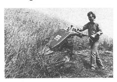
Bedienungskomfort wird beim Reform 416 grossgeschrieben. Eine besondere Neuheit stellt die Einzelradlenkung dar. Die griffgünstig angeordneten Lenkkupplungshebel mit hydraulischer Kraftübertragung sorgen für feinfühliges und ruckfreies Lenken – ohne Kraftanstrengung. Bequemes, ermüdungsfreies Arbeiten auch im ungünstigen Gelände ist damit gewährleistet.
