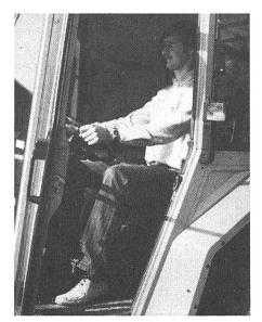
3: Bei tiefstehender Sonne reicht auch ein grosses, gut isoliertes Kabinendach nicht aus, um die Wärmestrahlung genügend abzuhalten. Farbgetönte Scheiben und eher helle Kabinenauskleidungen sind von Vorteil.
