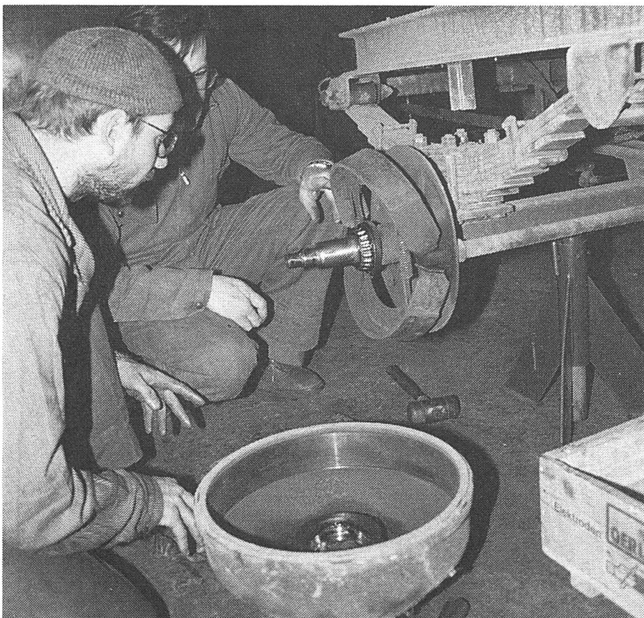
... funktionstüchtige Bremsen von grossem Nutzen sind. Im Rahmen eines Kurses des SVLT werden abgenutzte Bremsbeläge durch neue ersetzt.
