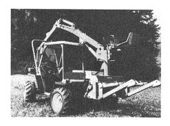
Zur Lagerung des Ladeskrans LEON T 400-360/S ist lediglich eine Fläche von 105 x 265 cm erforderlich. Ein rascher An- und Abbau an das Arbeitsfahrzeug ist durch eine Person problemlos möglich.
