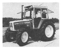
Mit den Kabinen ist es wie mit vielen anderen Traktorausrüstungen: was im einen Betrieb vorteilhaft ist, ist im anderen nachteilig oder überflüssig. So wünschen sich Betriebe, die mit dem Traktor in den Stall fahren, eine möglichst niedrige Kabine, Ackerbaubetriebe dagegen eine hohe, da diese mehr Luftraum und Bewegungsfreiheit bietet. Forstund Obstbaubetriebe schätzen derum eine schmale Kabine, Kommunalbetriebe eine breite, um auch den Beifahrer beguem unterzubringen, usw.
