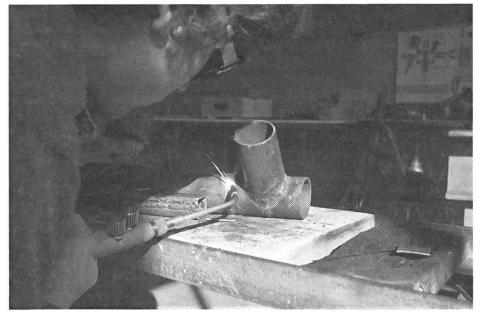
Zum Schweissen von Stahlröhren wird die Grösse des Schweissbrenners entsprechend der Wandstärke des Rohres gewählt. Der Durchmesser des Schweissdrahtes wählt man nach der Formel: Halbe Blechdicke (Wandstärke) + 0,5 mm.
