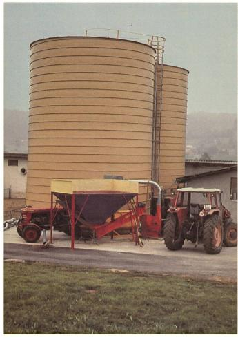
Abb. 3: Einfüllen von CCM in den Silobehälter. Notwendig sind Traktor mit Frontschaufel, Vorratstrichter für CCM mit Dosierband, Anteigstation mit Antrieb 30 kW und Wasseranschluss, Feuchtgetreidemühle mit Antrieb über 120 kW. Einfülleistung mit 1-Mann-Bedienung 25 t/h.
