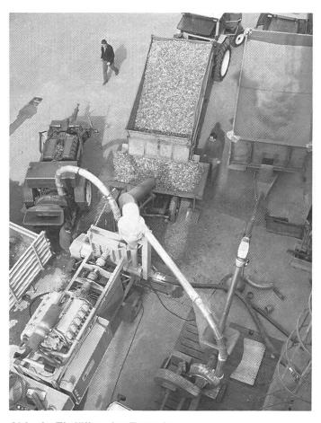
Abb. 1: Einfüllen der Futterkomponenten in den Silobehälter.
