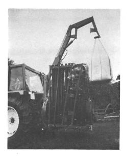
verlassen braucht. Mit dieser Maschine, die sich am Heck des Schleppers und daher zwischen dem Schlepper und der Streumaschine befindet, kann ein Mann in abgelegenen Bereichen die ganze Arbeit – z.B. des Düngemittel-
