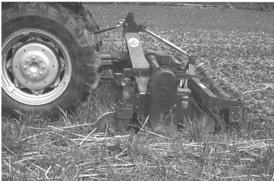
Soll auf den Pflug oder den Grubber als Werkzeuge für eine tiefe Lockerung verzichtet werden, muss der Boden in einem guten Zustand sein (Spatenprobe!). Das Stroh des Weizens als Vorfrucht wurde hier grob eingemulcht und darauf Sonnenblumen angesät. Die abgefrorenen Stengel wurden kurz vor der Vorführung abgeschlegelt. Mit verschiedenen Zinkenrotoren wurden die Rückstände oberflächlich eingearbeitet.
