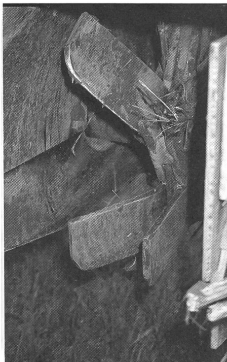
Detail von der Streifenfräse, die Messer bearbeiten den Boden pro Reihe etwa 12–15 cm breit.
