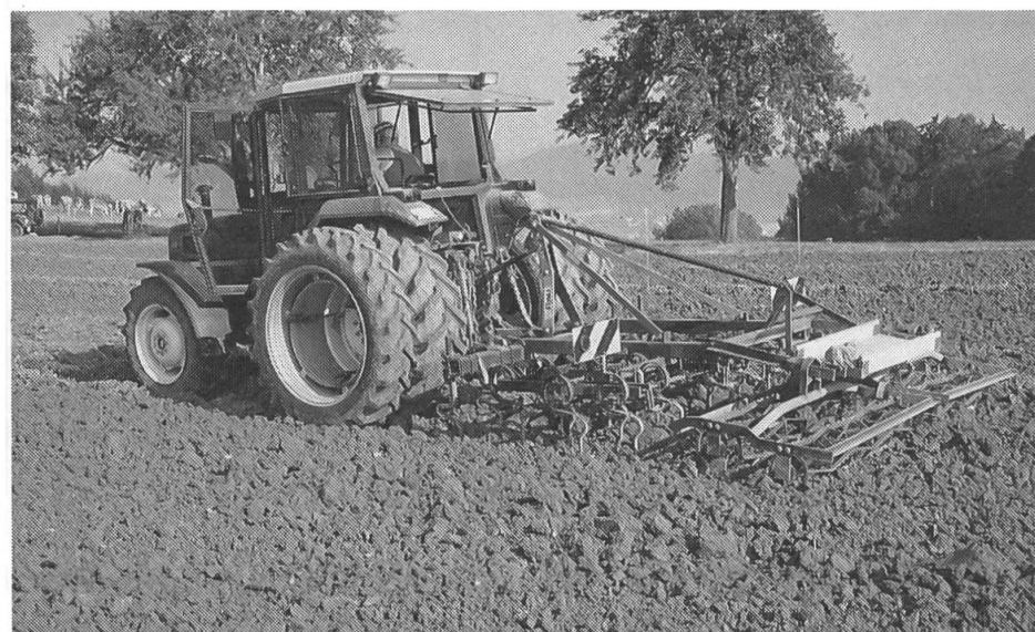
Abb. 3: . . . als auch beim Eggen wird mit dem Selbstsperrdifferential beim Allradtraktor keine nennenswerte Schlupfminderung erzielt.
