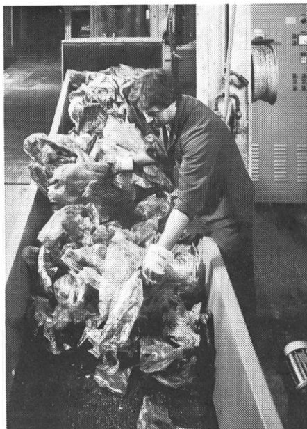
Kunststoffe aus Polyäthylen, Polypropylen und Polystyrol gelangen in die Zerkleinerungsmühle am Anfang des Recyclingprozesses.
