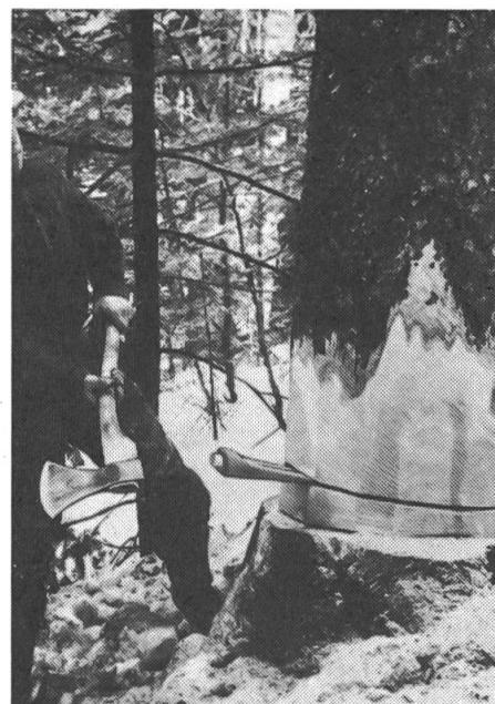
Dank seiner asymmetrischen Form und den Führungsprofilen auf der Unter- und Oberseite dringt der neue FZ-Fällkeil Mod. Bolle bedeutend leichter, waagrecht und ohne seitlich auszubrechen in den Fällschnitt ein.
