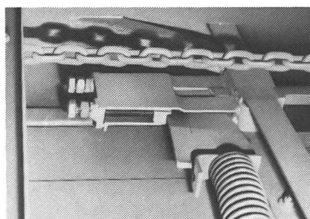
Eine automatische Kratzboden-Spannvorrichtung sorgt bei Mengele Ladewagen und Lade-Automatikwagen für erheblich weniger Wartungsaufwand.
