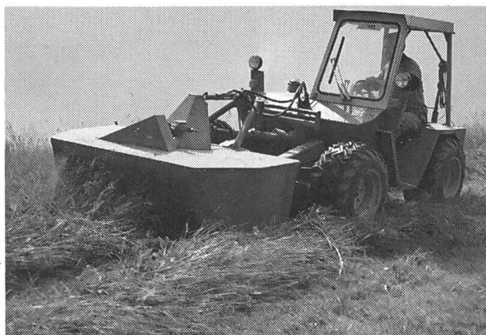
Abb. 5: Grosse Zweiachsmäher weisen ein günstiges Verhältnis zwischen Motorleistung und Eigengewicht auf. Dadurch sind sie hangtauglich, leistungsfähig und vielseitig verwendbar, auch für leichte Ackerarbeiten bei geringer Spurbildung.
