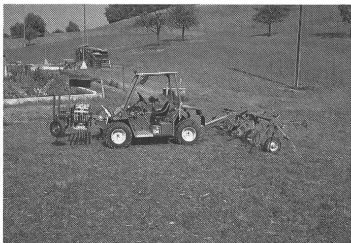
Abb. 3: Kleinere Zweiachsmäher werden häufig in Betrieben mit einem hohen Anteil Steillagen eingesetzt. Als wichtigste Anbaugeräte neben dem Mähwerk kommen der Bandrechen und Kreiselheuer in Betracht. Aus Sicherheitsgründen ist bei diesen kleinen Maschinen der gezogene Kreiselheuer vorteilhafter.
