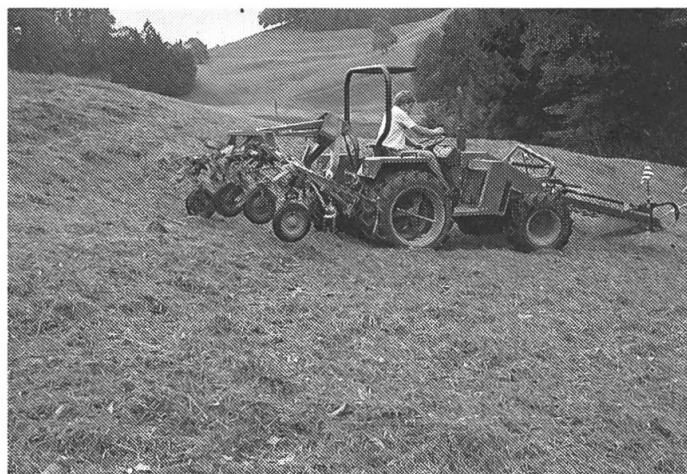
Abb. 6: Bei den Traktorvarianten handelt es sich um speziell abgeänderte Traktoren. Am auffälligsten ist die Herabsetzung der Motorhaube, um eine bessere Sicht auf die Frontgeräte zu bieten. Die vermehrte Belastung der Vorderachse durch Frontgeräte und Terrareifen erfordert in der Regel eine Verstärkung der Antriebselemente.
