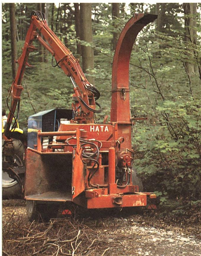
*Die kompakt gebaute Holzhackmaschine ist auch bei engen Platzverhältnissen beweglich und kann dadurch optimal neben dem Polter plaziert werden.*
