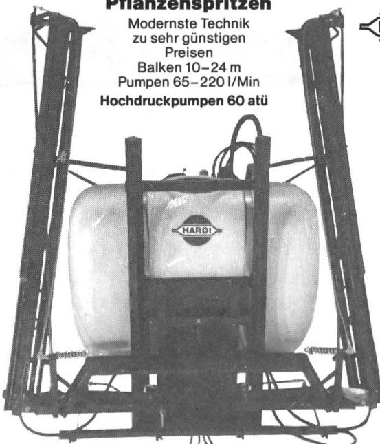
Hydraulische Höhenverstellung. Hydraulisches Zusammenklappen.
