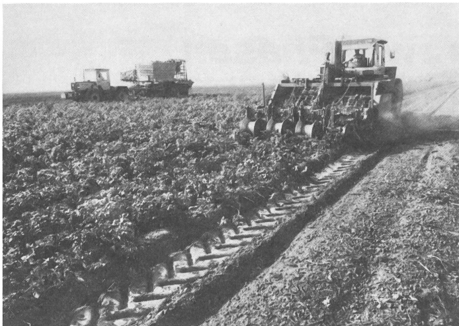
Prototyp eines vierreihigen geschobenen Schwadenlegers mit integriertem Krautschläger, dahinter ein Ladebunker bei einer Schwadaufnahme.
