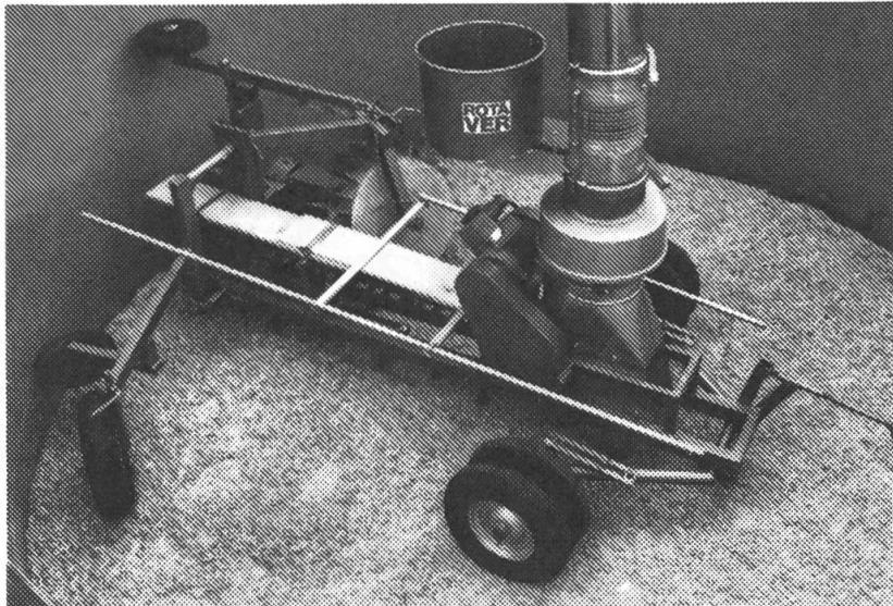
Hochleistungs-Silofräse TAURUS zur vollautomatischen Entnahme von Mais-, Gras- und CCM-Silage.
