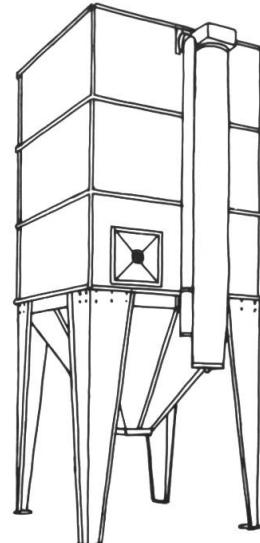
Zur Selbstmontage liefern wir Silos im Baukastenprinzip. Verzinkte Ausführung mit 60°-Trichter. Austragung mit Schnecke oder Auslaufschieber. Silos von 500-10000 kg Inhalt.
