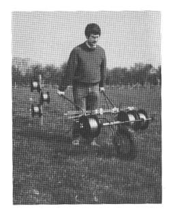
Eine grosse Zeitersparnis und Ordnung bringt Ihnen dieses einzigartige pat. Gerät in der Errichtung von Elektrozäunen. Bis zu 4 Drähte können gleichzeitig auf- und abgespult werden. Rutschkupplungen geben immer einen gleichmässigen Zug auf allen Drähten.
