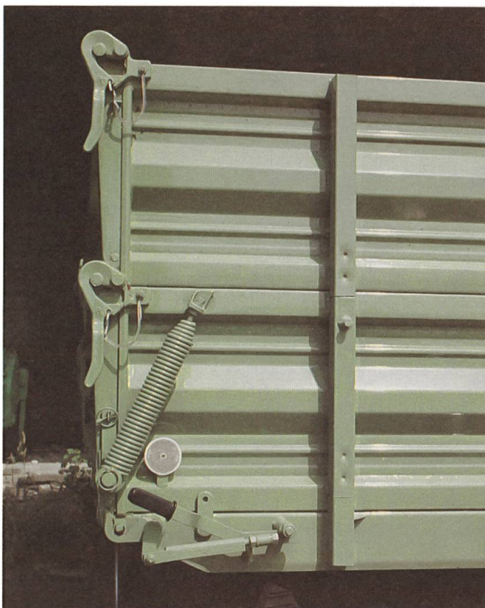
Vorstehende Verschlüsse stellen Gefahrenquellen dar. Sie werden zudem leicht beschädigt
