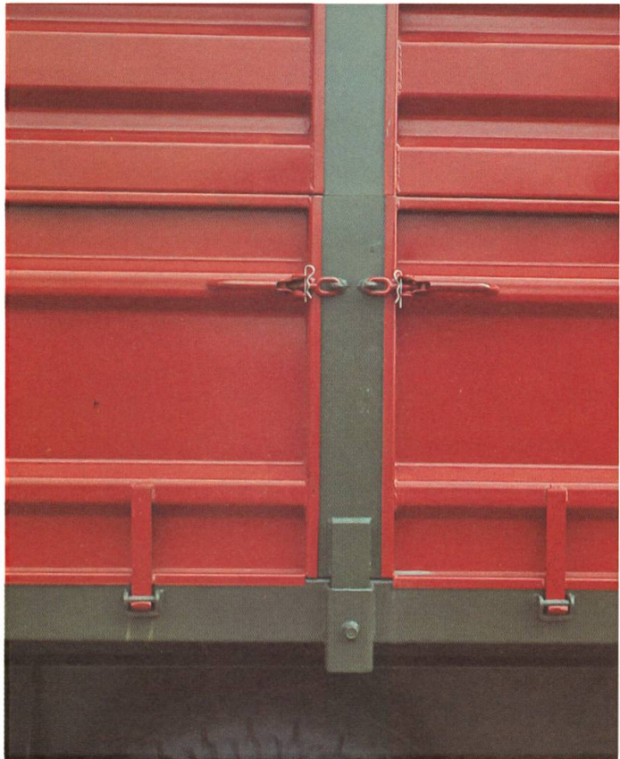
Mittelpfosten (-rungen) erhöhen bei langen Seitenwänden die Stabilität und erleichtern das Hoch- und Abklappen der Seitenwände.
