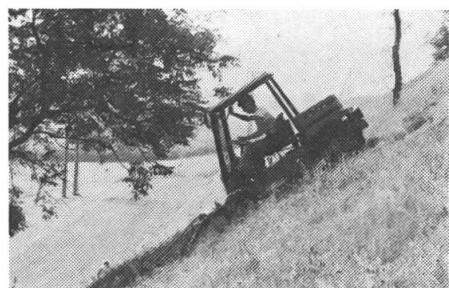
*Für das Mähen an steilsten Hanglagen ist der TM-600 besonders geeignet.*
