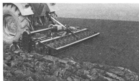
Auf den Herbst 1988 wird die Rototiller-Modellreihe ergänzt mit dem Modell REC mit 3-Gang-Schaltgetriebe in den Arbeitsbreiten 2,50 und 3,00 m, mit seitlich angeordnetem Schalthebel zum schnellen Schalten der Geschwindigkeiten (bis max. 100 PS zulässig).
