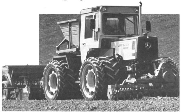
Für ausgefeilte Produktionstechniken bietet der MB-trac die idealen Voraussetzungen: Drei vollwertige Anbauräume, ein starker Rahmen und zwei gleich starke Achsen mit hohen zulässigen Achslasten ermöglichen den An- und Aufbau leistungsfähiger Gerätekombinationen.
