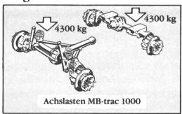
Durch die Gewichtsverteilung von 60:40 (vorn/hinten) ist hierbei sichergestellt, daß bei der Arbeit beide Achsen gleichmäßig belastet werden. Für den reibungslosen Betrieb der Geräte sorgen Kraftheber und vollbelastbare Zapfwellen an Front und Heck. Beide Zapfwellen sind von 540/min auf 1000/min umschaltbar. Mit sinnvollen Gerätekombinationen arbeiten Sie nicht nur rationeller und wirtschaftlicher, Sie vermeiden auch Bodenverdichtungen und erhalten die Bodenfruchtbarkeit.
