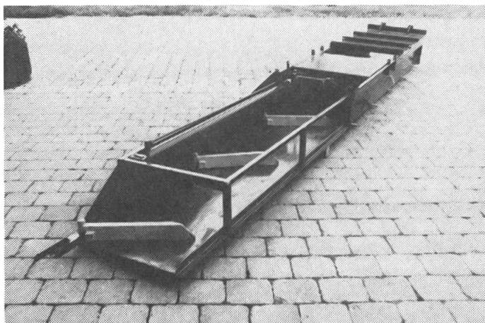
Abb. 2: Die Schubstange endet mit einem verstärkten Schiebeschild in der Druckkammer.
