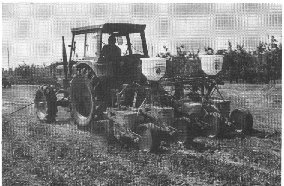
Direkt-Sämaschine Kleine/Maxi Corn S, (Einzelkornsystem), Fräse System Döni/Odermatt, Arbeitsbreite 4 x 75 cm.
