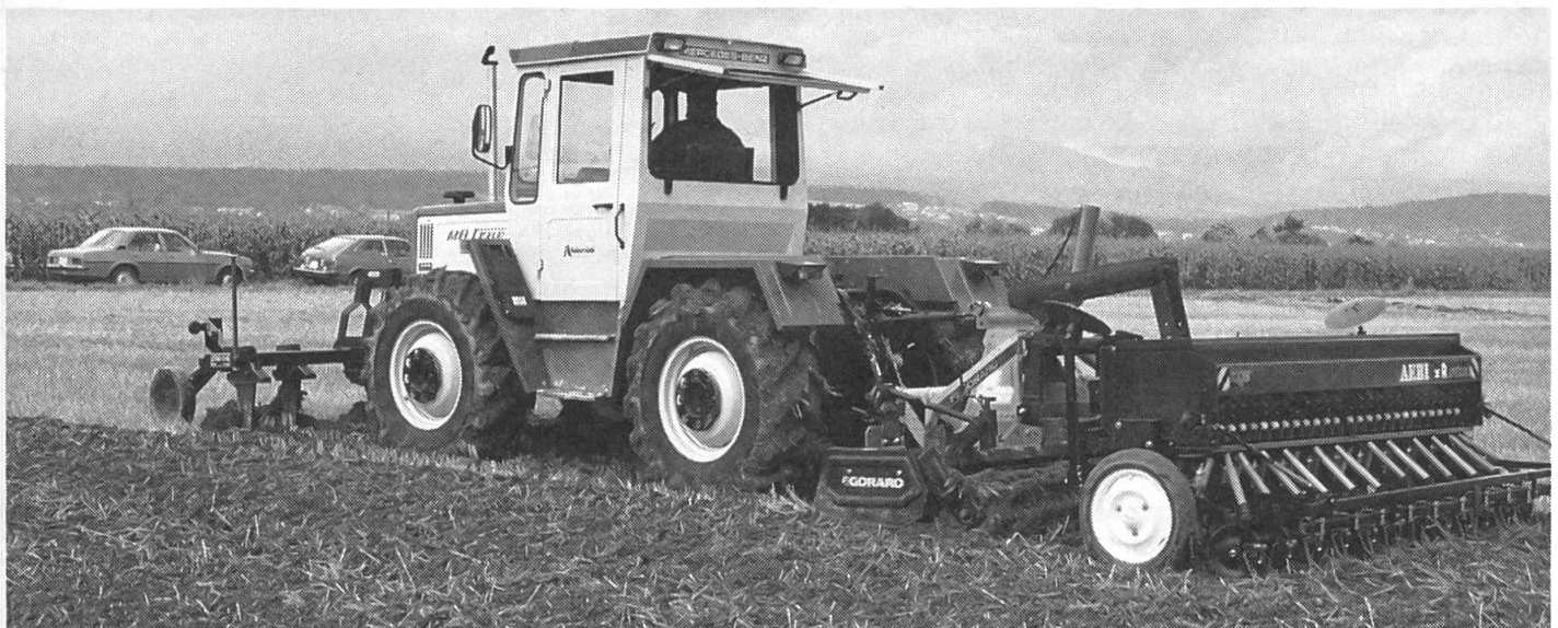
Mit dieser Kombination erfolgen Stoppelbearbeitung und Saat in einem Arbeitsgang. Die dazu erforderlichen Traktoren sind aber schwierig auszulasten.
