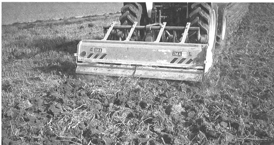
Die Spatenmaschine vermag Ernterückstände besser einzumischen als der Pflug.
