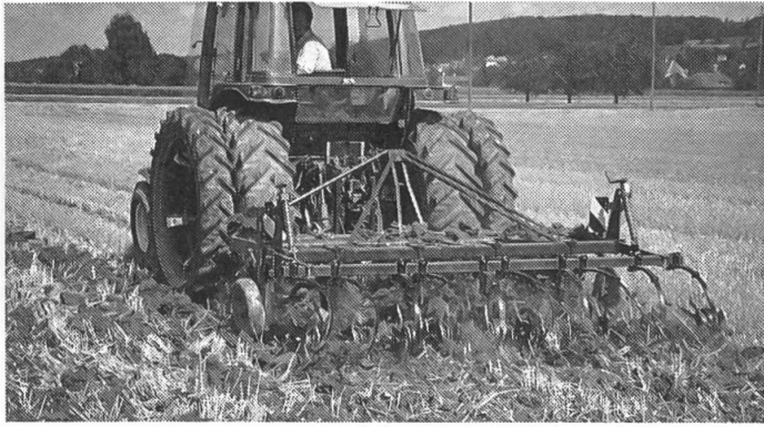
Grubber mit Spatenrollelementen als Nachläufer.
