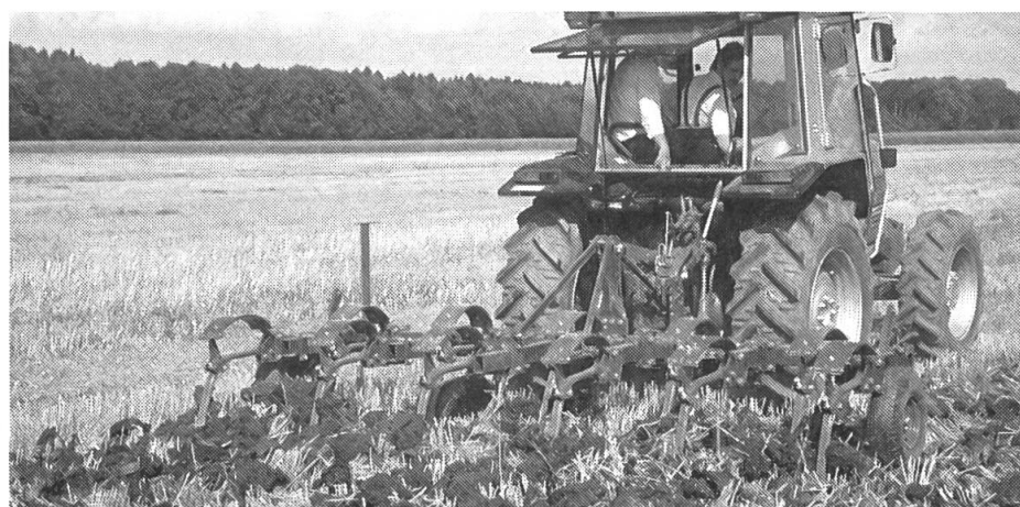
Grubber mit Steinsicherung, ohne Nachläufer entsteht eine grobschollige Oberfläche.
