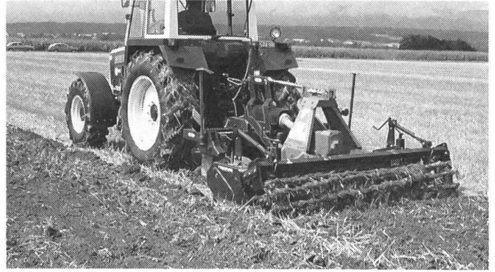
Kombination Kurzgrubber und Kreiselegge. Auch bei der Stoppelbearbeitung darf der Boden nicht in zu feuchtem Zustand bearbeitet werden.
