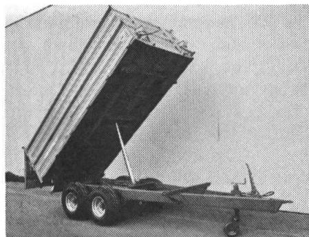
Die Serie der Mengele 3-Seitenkipper in Schweizerausrüstung ist mit einer neuen Zentralverriegelung der Bordwände versehen worden. Der durchgehende, nahtlos geschweißte Brückenboden mit dem seitlichen, selbtreinigenden Brückenprofil garantiert eine lange Lebensdauer und störungsfreies Arbeiten.
