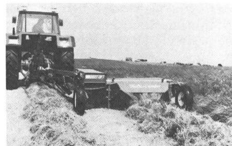
Die gezogenen JF-Mähaufbereiter CMT-245 erfreuen sich einer immer grösseren Beliebtheit, da sie trotz 245 cm Arbeitsbreite mit Traktoren ab 60 PS Zapfwellen PS betrieben werden können. Die serienmässige hydraulische Schwenkdeichsel macht diese gezogenen Mähaufbereiter dermassen wendig, dass sogar Obstgärten einfacher gemäht werden können als mit einer 3-Punkt Maschine.
