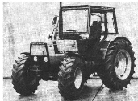
Mit dem Deutz-Fahr DX 3.65, aufgebaut auf dem DX 3.60, steht eine bedeutende Ergänzung der Angebotspalette in der 70 PS (51 kW) Leistungsklasse zur Verfügung.
