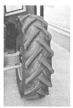
Abb. 3: Ackerreifen – Grünlandreifen Ein ausgesprochener Ackerreifen ist gekennzeichnet durch schmale und in der Mitte der Lauffläche kaum überlappende Stollen (links). Grünlandreifen haben zur Schonung der Grasnarbe breitere und in der Lauffläche stark überlappende Stollen (rechts).
