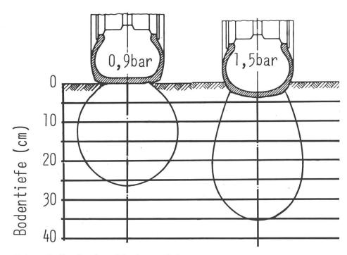
Abb. 2: Reifendruck und Bodenverdichtung
