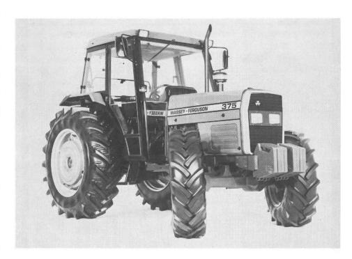
Traktor der neuen 3er Bauereihe (47–62 PS mit folgenden Merkmalen: Neue Allradachse (Lenkeinschlag 52 Grad) Vollsynchron-Wendegetriebe mit 24 Vorwärts- und 12 Rückwärtsgängen neue Mauser-Sicherheitskabine aufgebaut auf einer gummigelagerten Plattform, Zapfwelle mit 540 und 758 U/min. umschaltbar sowie Weg und Grünlandzapfwelle, neue Hydrauliksteuerung, Stufenhaken mit Schnellverstellung und viele weitere Details, die dem Schweizer Landwirt die Arbeit erleichtern.
