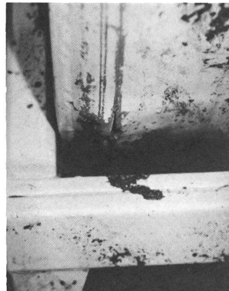
Abb. 11: Durch Steinbesatz verursachter Gehäuseschaden. Solche Reparaturen sind kostspielig; es gilt, sie durch geeignete Massnahmen (s. Kästchen) zu vermeiden.
