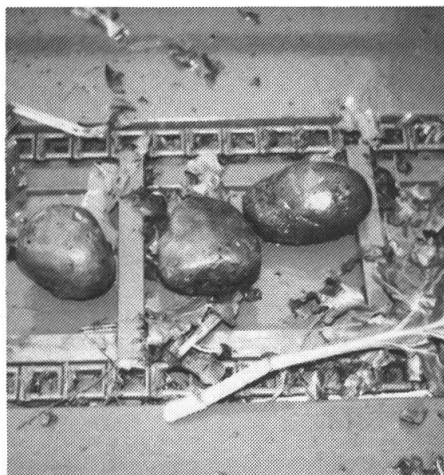
Abb. 9: Solche Steine sowie Kreiselheuerzinken und ähnliches sind Gift für den Häcksler.
