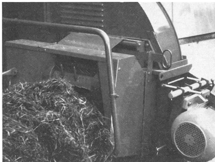
Abb. 2: Fünf der geprüften Häcksler verfügten über solche Einzugswalzen, vier davon mit gesteuerten Zinken. Die Walzen lassen sich bei der Maisförderung entlasten und anheben, damit die Einzugsöffnung grösser wird.
