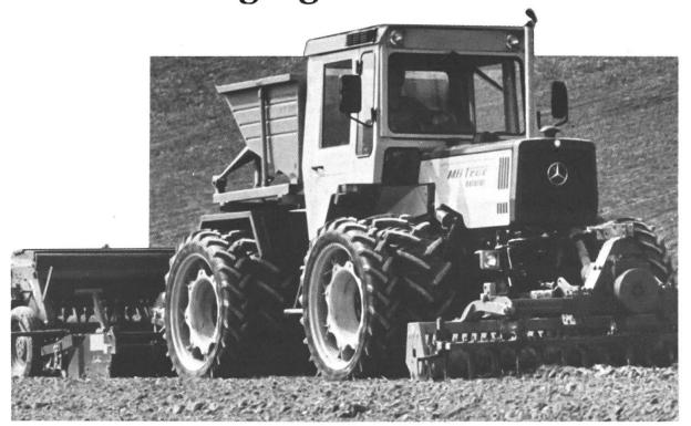
Für ausgefeilte Produktionstechniken bietet der MB-trac die idealen Voraussetzungen: Drei vollwertige Anbauräume, ein starker Rahmen und zwei gleich starke Achsen mit hohen zulässigen Achslasten ermöglichen den An- und Aufbau leistungsfähiger Gerätekombinationen.
