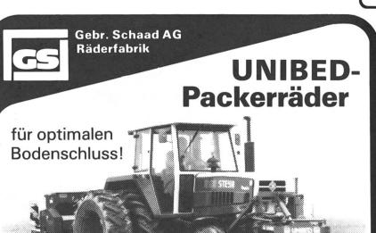
Verhindert Bodenverdichtung und erlaubt das Säen gleich nach dem Pflügen im Einmann-Passage-Verfahren.
