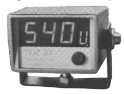
Das schon weitverbreitete und beliebte Geschwindigkeit-Anzeigegerät Tachotron TT84 wurde in seinen Möglichkeiten erweitert und kann in der Ausführung TDZ87 nun auch die Zapfwelle-Drehzahl messen und anzeigen.
