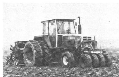
den Schlepperrädern der optimale Bodenschluss hergestellt wird. Die Unibed-Packerräder sind lenkbar und über einen Hydraulikzylinder beliebig belastbar. Die Unibed-Pakkerräder können mit wenigen Steckbolzen an- und abgekuppelt werden. Als Hydraulikanschluss genügt ein doppelt wirkenden Hydraulikanschluss. Weitere Auskünfte erhalten Sie über:
