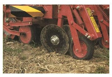
Verstellbare Räumscheiben mit Tastrad vor dem Säaggregat einer herkömmlichen Einzelkornsämaschine ermöglichen eine verstopfungsfreie Direktsaat.
