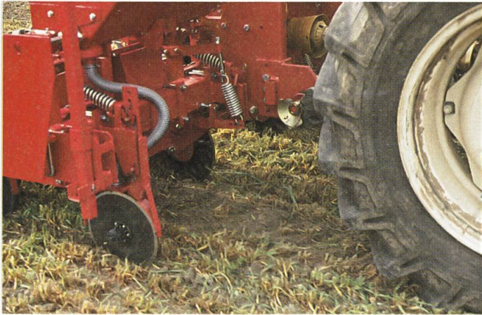
Mit Hilfe eines geriffelten Scheibensechs (Mitte) vor dem Säaggregat und Doppelscheibenscharen für den Reihendüngerstreuer ist eine Direktsaat in abgeernteten Grünrognen problemlos durchführbar.
