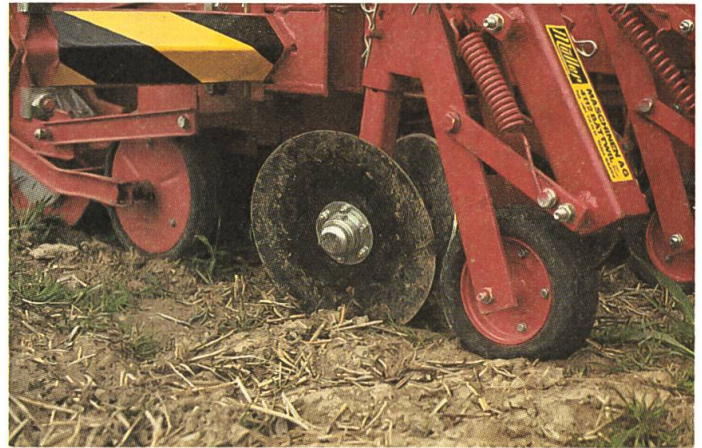
Verstellbare Räumscheiben mit Tastrad vor dem Säaggregat einer herkömmlichen Einzelkornsämaschine ermöglichen eine verstopfungsfreie Direktsaat.
