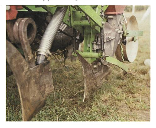
maisanbau entwickelte Becher-Einzelkornsämaschine bewährt. An einem Rad sind Stechbecher angeordnet, die sich beim Eindringen in den Boden zur Saatgutablage öffnen. (Versuche haben gezeigt dass der Folienmaisanbau für die Praxis nich in Frage kommt.)
