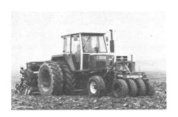
den Schlepperrädern der optimale Bodenschluss hergestellt wird. Die Unibed-Packerräder sind lenkbar und über einen Hydraulikzylinder beliebig belastbar. Die Unibed-Pakkerräder können mit wenigen Steckbolzen an- und abgekuppelt werden. Als Hydraulikanschluss genügt ein doppelt wirkenden Hydraulikanschluss. Weitere Auskünfte erhalten Sie über:
