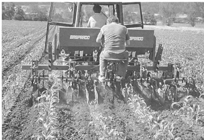
Abb. 6: Mit dem Scharhackgerät Gaspardo (mit Reihendüngerstreuer) lässt sich bei gut versetzten Hackscharen ein guter Arbeitseffekt erreichen.
