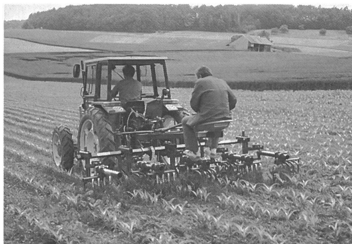
Abb. 8: Das Sternhackgerät Haruwy mit Lockerungszinken und spatenförmigen Hacksternen erbrachte auch unter extremen Einsatzbedingungen eine gute Arbeitsqualität. Für Häufelarbeit müssen die Hacksterne ausgewechselt werden.
