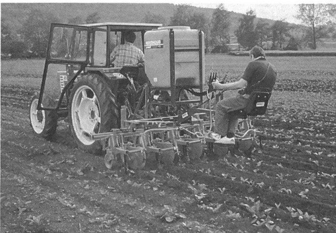
Abb. 4: Drei Scharen je Hacksatz sind besser als zwei, aber erst bei versetzter Anordnung (Bärtschi). Die Bandspritze ist eigentlich eine Feldspritze ohne Spritzgestänge (Berthoud).
