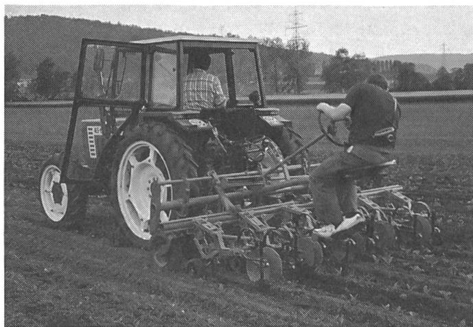
Abb. 2: Das Hackgerät mit Vibro-Gänsefußscharen und Parallelsteuerung erbrachte eine gute Arbeitsqualität. Rechts: Unkrautfreier Rübenbestand nach zweimaligen Hacken im Mineralboden.
