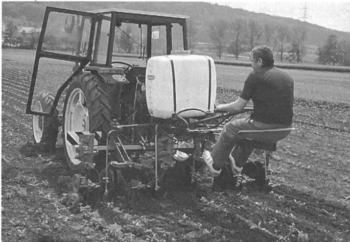
Abb. 3: Beim Vielfachgerät Haruwy werden die Traktorspuren mit starrgeführten Hacksätzen gründlich aufgelockert. Die Befestigung der Düsen – an runden Schutzscheibenhaltern hat sich weniger gut bewährt (Bandspritze Fischer).
