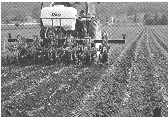
Abb. 1: In der Ebene ist das Hacken mit gleichzeitiger Herbizidbandspritze im Einmannbetrieb gut möglich (Rau). Vorteile: Drei Schare an gefedertem Halter je Hacksatz, Spindelverstellung, auch in Mais einsetzbar (Rahmen unter 3 m erhältlich).
