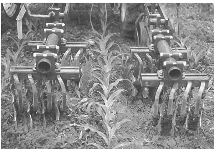
Abb. 8: Das Sternhackgerät Haruwy mit Lockerungszinken und spatenförmigen Hacksternen erbrachte auch unter extremen Einsatzbedingungen eine gute Arbeitsqualität. Für Häufelarbeit müssen die Hacksterne ausgetauscht werden.
