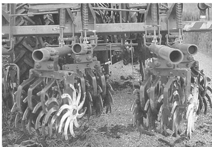
Abb. 7: Die Arbeitsintensität kann durch die Schrägstellung der bodenangetriebenen Hacksterne reguliert werden. Die symmetrisch zugespitzten Sterne müssen für eine Häufelarbeit nur gedreht werden. Für harte Böden ist das Verwenden von Lockerungszinken angezeigt (Müller).
