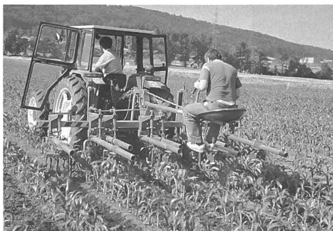
Abb. 7: Die Arbeitsintensität kann durch die Schrägstellung der bodenangetriebenen Hacksterne reguliert werden. Die symmetrisch zugespitzten Sterne müssen für eine Häufelarbeit nur gedreht werden. Für harte Böden ist das Verwenden von Lockerungszinken angezeigt (Müller).
