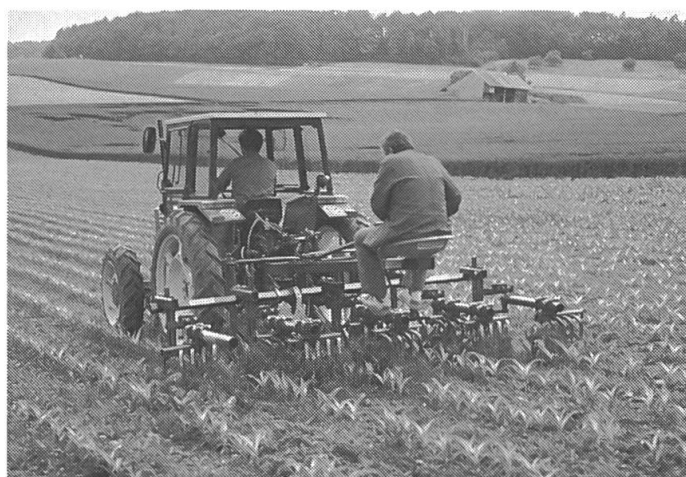
Abb. 8: Das Sternhackgerät Haruwy mit Lockerungszinken und spatenförmigen Hacksternen erbrachte auch unter extremen Einsatzbedingungen eine gute Arbeitsqualität. Für Häufelarbeit müssen die Hacksterne ausgetauscht werden.
