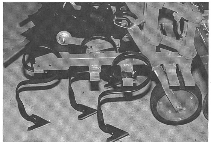
Abb. 1: In der Ebene ist das Hacken mit gleichzeitiger Herbizidbandspritzung im Einmannbetrieb gut möglich (Rau). Vorteile: Drei Schare an gefedertem Halter je Hacksatz, Spindelverstellung, auch in Mais einsetzbar (Rahmen unter 3 m erhältlich).
