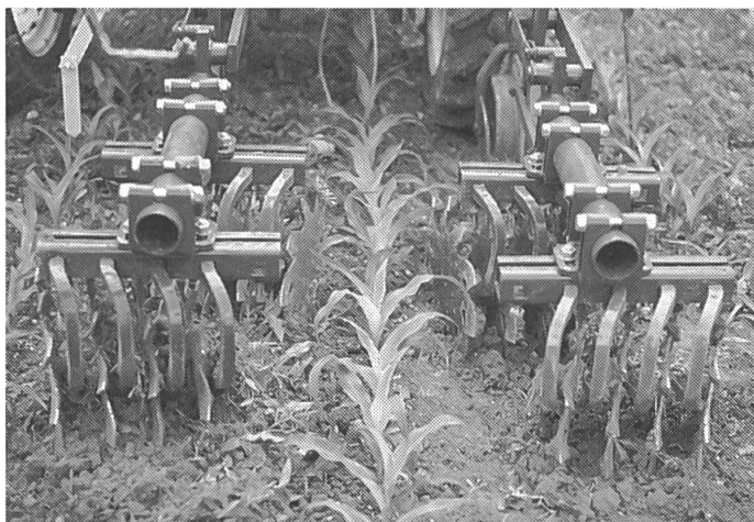
Abb. 8: Das Sternhackgerät Haruwy mit Lockerungszinken und spatenförmigen Hacksternen erbrachte auch unter extremen Einsatzbedingungen eine gute Arbeitsqualität. Für Häufelarbeit müssen die Hacksterne ausgewechselt werden.
