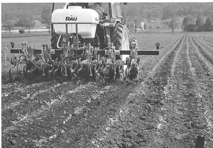
Abb. 1: In der Ebene ist das Hacken mit gleichzeitiger Herbizidbandspritzung im Einmannbetrieb gut möglich (Rau). Vorteile: Drei Schare an gefedertem Halter je Hacksatz, Spindelverstellung, auch in Mais einsetzbar (Rahmen unter 3 m erhältlich).
