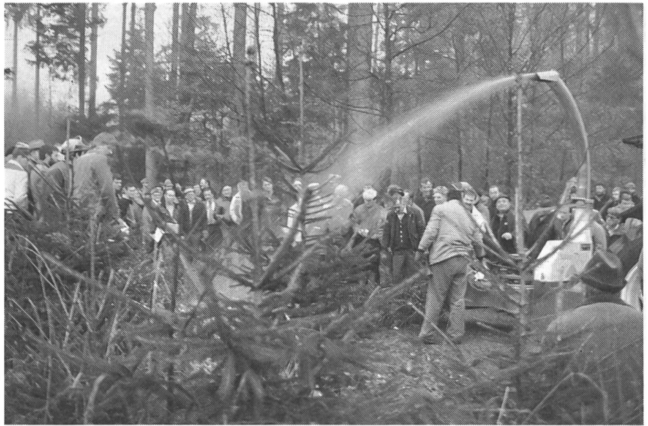
Anbauhäcksler mit hydraulischem Einzug und Scheibenrad in Aktion (Anschaffungspreis rund Fr. 18'000.-).
