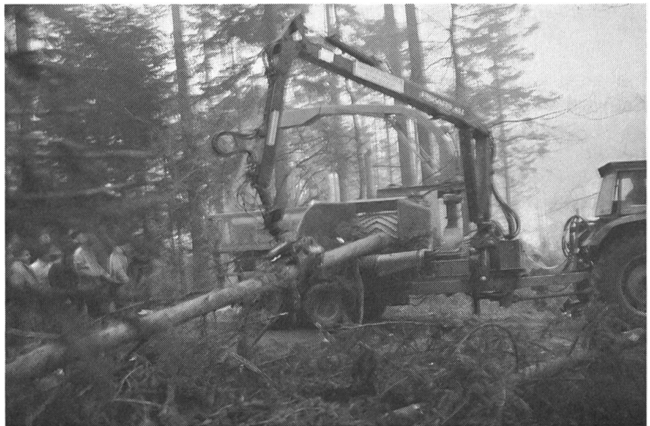
Gross-Häcksler mit 250 PS-Aufbaumotor. Der Einzugsquerschnitt zur Häckseltrommel mit prozessorgesteuertem Einzug beträgt 70 x 40 cm, die Durchsatzleistung 20–40m 3 /h, bei einem Dieselverbrauch (mit Zugfahrzeug) von etwa 1,6 l/m 3 Schnitzel. Anschaffungspreis rund Fr. 300'000.-, Einsatz durch einen Aargauer Lohnunternehmer.
