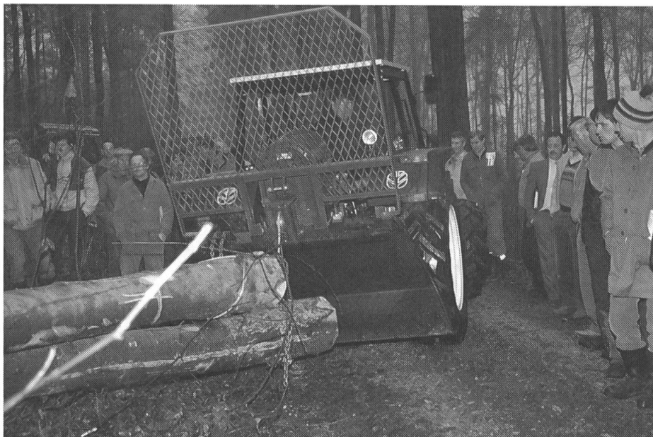
Seilwinden ermöglichen ein wesentlich rationelleres Holzrücken. Sie müssen aber den Sicherheitsanforderungen entsprechen, hier darf keinesfalls gespart werden!
