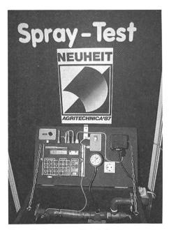
Spraytest zur Vereinfachung des Spritztestes. Abgesehen von der Beobachtung des Spritzenbildes und der Verteilung der Spritzflüssigkeit soll es möglich sein, damit sämtliche Kenngrössen eines Spritzengerätes zu messen, beziehungsweise in Abhängigkeit der simulierten Fahrgeschwindigkeit und Breite des Spritzbalkens die Ausbringmenge einzustellen. Nicht messbar ist die Verteilung der Spritzbrühe in Abhängigkeit der Düsenform.
