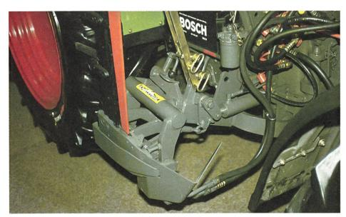
wird die bewährte Regelhydraulik mehr und mehr durch die elektronische Hubwerksregelung (EHR) ersetzt. Ihr Einbau ist verhältnismässig problemlos. Die Bedienung ist innerhalb vorgewählter Maximalstellungen durch Knopfdruck auch vom Heck her möglich. Im Zusammenhang mit der EHR werden auch Radargeräte zur Messung der effektiven Fahrgeschwindigkeit und für die Ableitung des Schlupfes angeboten.
