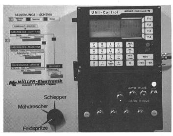
Bordcomputer «Uni-Control» für Überwachungsund Steueraufgaben. Der Lohnunternehmer kann die Daten für die Rechnungstellung abrufen bzw. über kurz oder lang auf elektronischem Weg direkt auf den PC übertragen.
