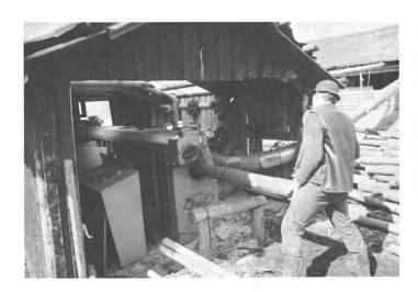
Aus Rundholz werden zylindrisch gefräste Stangen.
