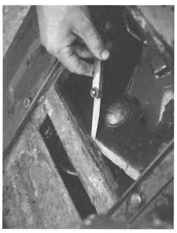
Schneidspalt über die ganze Breite kontrollieren.
