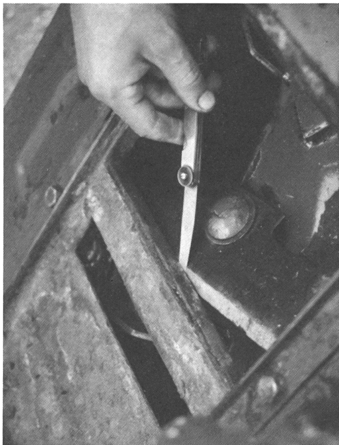
Schneidspalt über die ganze Breite kontrollieren.
