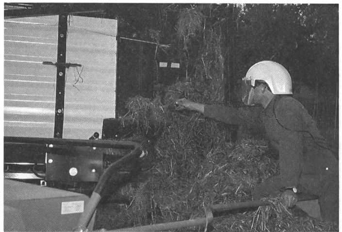
2: Auf der freien Seite des Beschickungstisches muss eine Abschränkung angebracht sein, die das Betreten oder Überqueren verhindert. Bei neueren Modellen ist sie mit dem Abstellbügel verbunden, so dass das Zuführorgan auf der ganzen Länge abgestellt werden kann.
