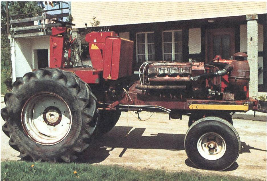
Das Chassis und der V8-Deutz-Dieselmotor (230 PS) stammen von einem aus- rangierten Beton-Fahrnischer, der über eine Hydropumpe verfügt hat, wie sie auch in Mähdreschern verwendet wird. (Die Hydropumpe ist durch den Luftfilter verdeckt.) Auf die Vorderachse montierte Leu den Führerstand Marke Köla und den Treibstofftank (Dieselverbrauch ca. 50 Liter pro Hektare). Für die Bestandteile des Lasters legte Leu ca. 1100 Franken aus, für diejenigen des Mäh- dreschers 1500 Franken.
